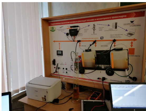
Рисунок 1 – Компоненты и органы управления стенда в режиме проверки датчика расхода топлива
